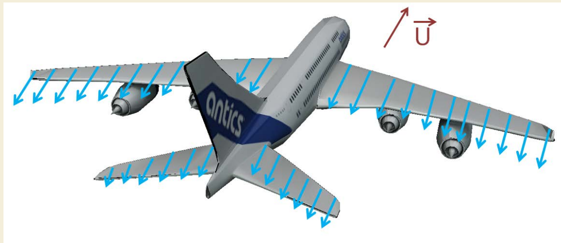
Силы сопротивления, действующие на самолет во время полета
