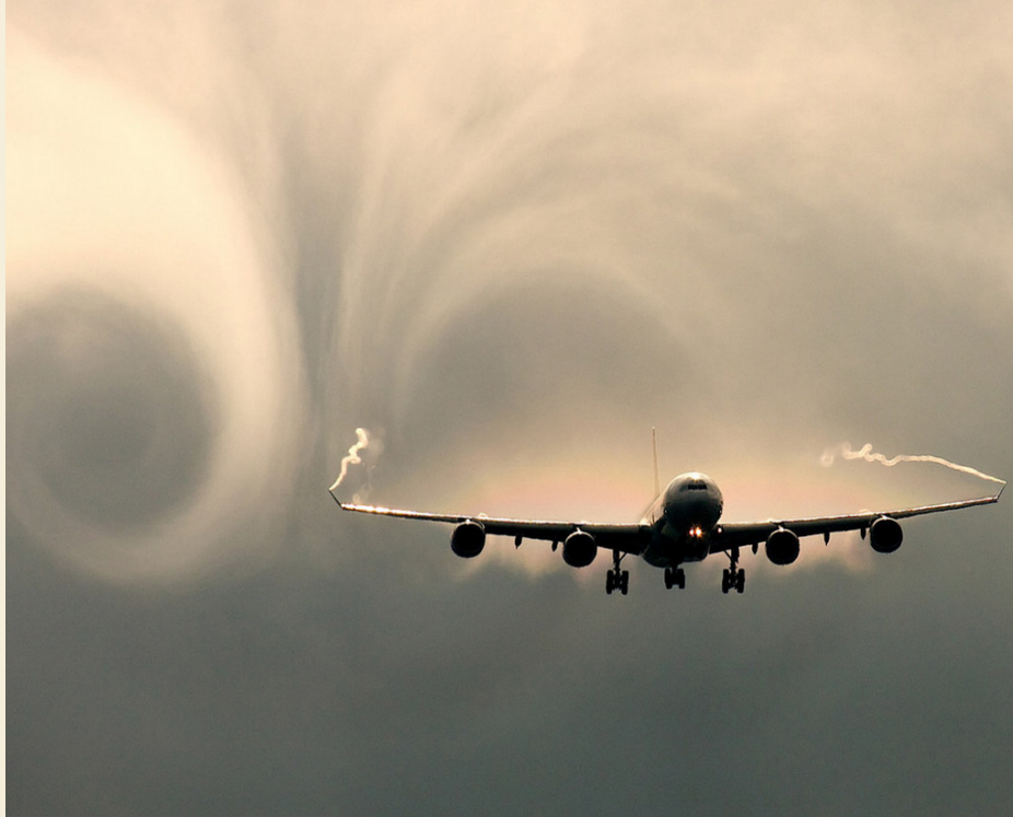
Рис.2. Турбулентные потоки за самолётом
