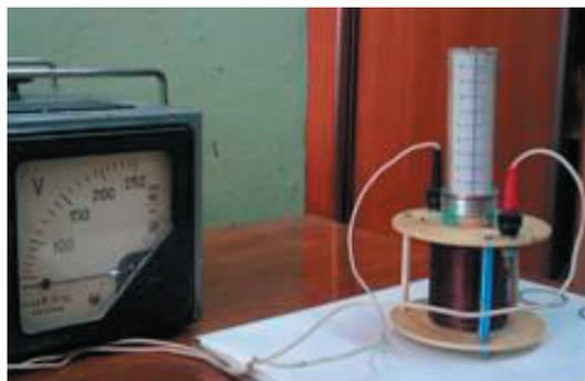
Рис. 3.16. Установка для исследования эффекта «плавающих колец» (трансформатор Э. Томсона)
