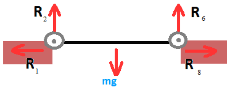
Рис. 8 Силы действ. на основную балку
