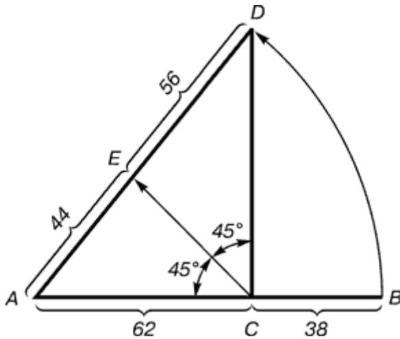
Деление осуществляется следующим образом. Отрезок  $AB$  делится в пропорции золотого сечения. Из точки  $C$  восставляется перпендикуляр  $CD$ . Радиусом  $AB$  находится точка  $D$ , которая соединяется линией с точкой  $A$ . Прямой угол  $ACD$  делится пополам. Из точки  $C$  проводится линия до пересечения с линией  $AD$ . Точка  $E$  делит отрезок  $AD$  в отношении  $56 : 44$ .
