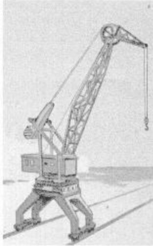
Портальные поворотные краны. Грузоподъемность - 300 кН. Скорость подъема груза - 0,17 м/с.
