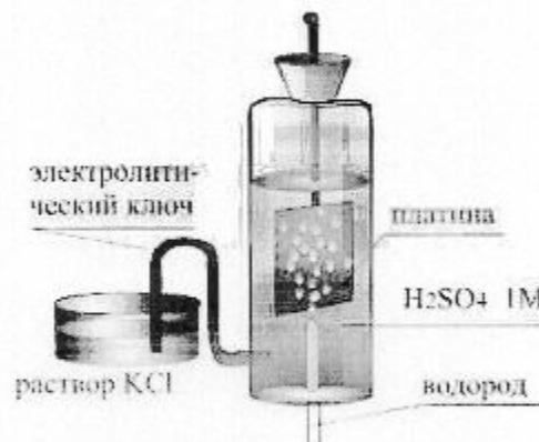
Рис.1 Стандартный водородный электрод
