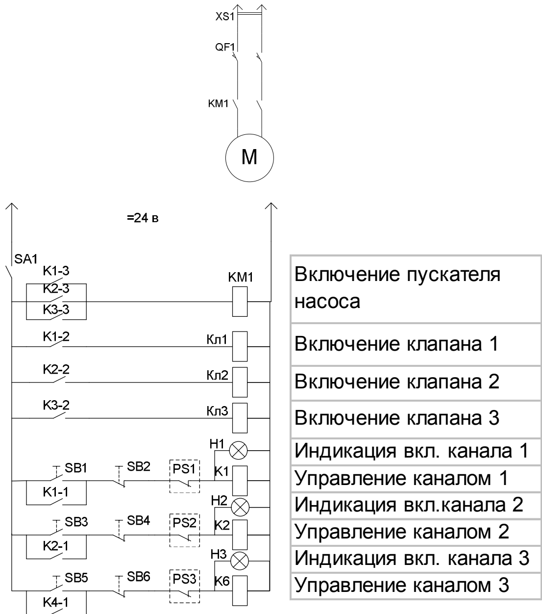
Рисунок 8 – Принципиальная электрическая схема управления на электромагнитных реле
