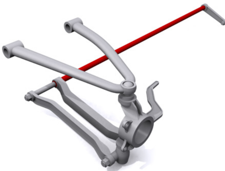
Рис. 4. Внешний вид торсионной подвески [4]
