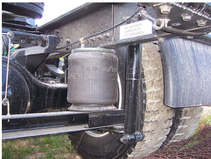
Рис.1. Внешний вид пневматической подвески [1]
