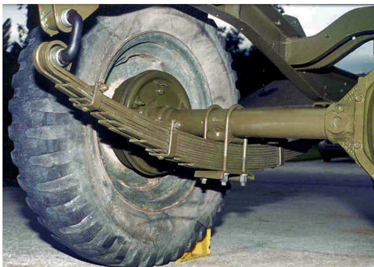
Рис. 3. Внешний вид рессорной подвески [3]
