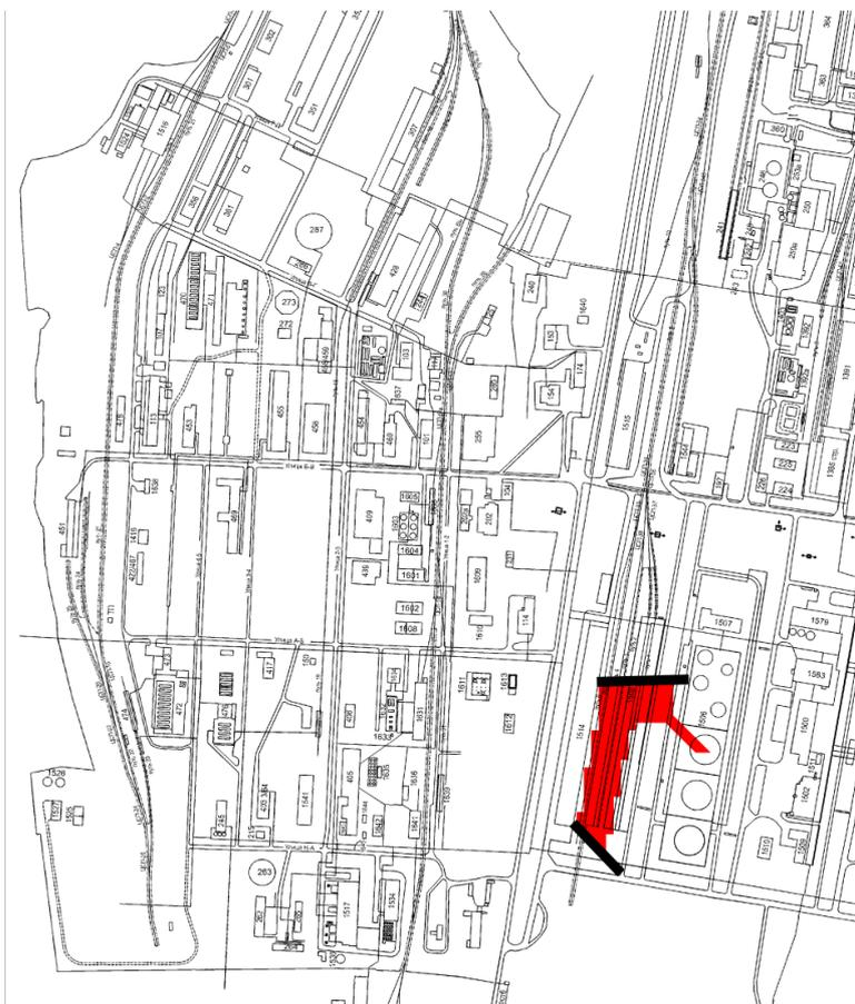
Рис. 10. Зона аварийного разлива при использовании дамб
