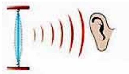
Источники звука — физические тела, которые колеблются, т.е. дрожат или вибрируют с частотой от 16 до 20000 раз в секунду. Вибрирующее тело может быть твердым, например, струна или земная кора, газообразным, например, струя воздуха в духовых музыкальных инструментах или в свистке либо жидким, например, волны на воде.
