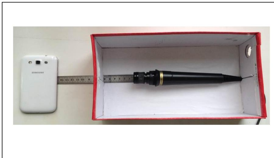
*Рисунок 3. Картонная коробка без дополнительной звукоизоляции*
