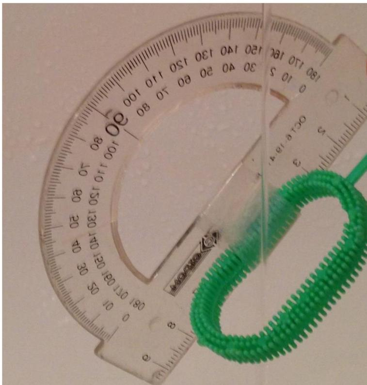
Далее натягиваем пленку заново и поворачиваем обратно на 2 градуса (повторяем несколько раз и мы найдем точный угол бета наклона от развернутого угла)
