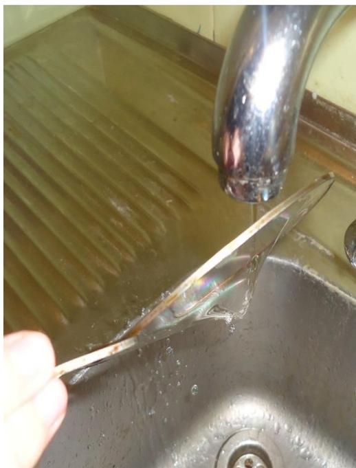
Вывод: струя начинает прилипать к пленке при отклонении от прямого угла на 38 градусов.
