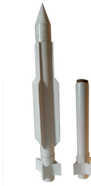
Рисунок 3 Внешний вид готовой ракеты и вынятый ракетный двигатель
