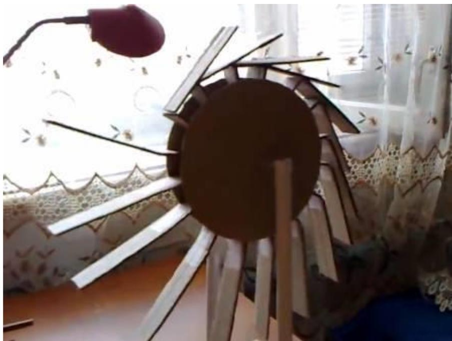
Мы выяснили, что это одна из древнейших конструкций вечного двигателя. Она представляет зубчатое колесо, в углублениях которого прикреплены откидывающиеся на шарнирах грузы. Геометрия зубьев такова, что грузы в левой части колеса всегда оказываются ближе к оси, чем в правой. По замыслу автора, это, в согласии с законом рычага, должно было бы приводить колесо в постоянное вращение. При вращении грузы откидывались бы справа и сохраняли движущее усилие.
