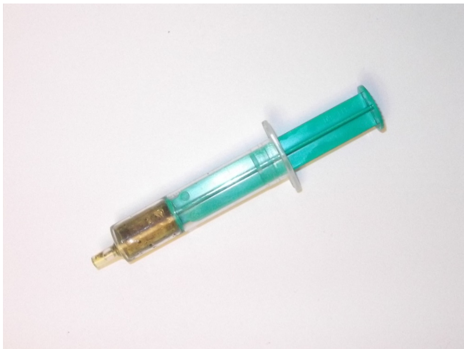
Рисунок 8 Шприц, наполненный смесью масла и металлической стружки
