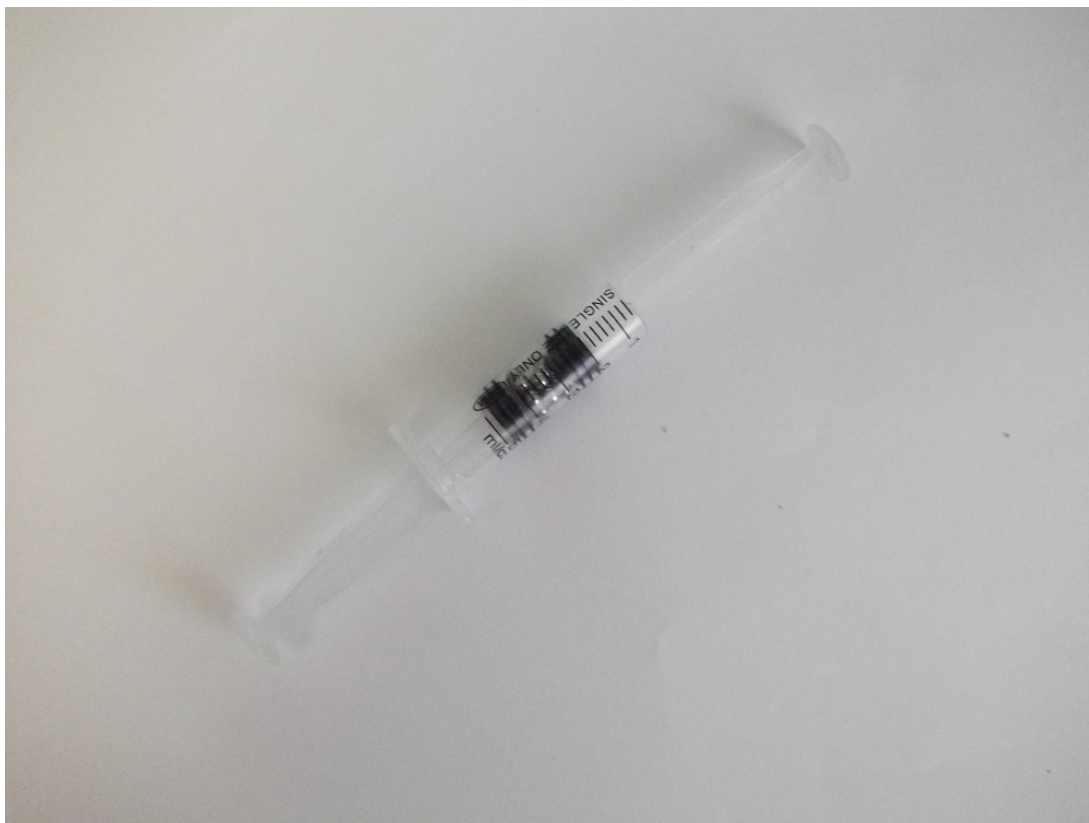
Рисунок 10 модель амортизатора - шприц с двумя поршнями
