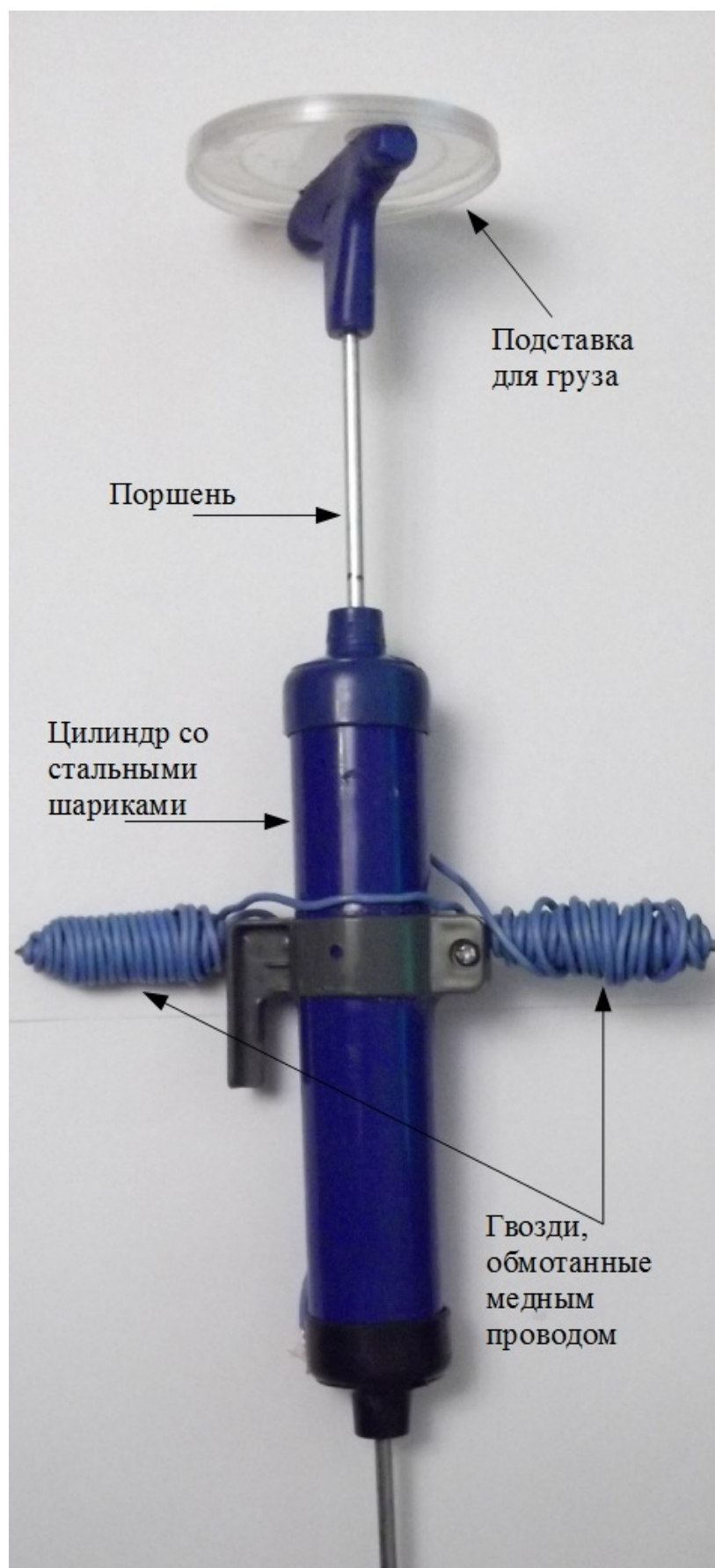
Рисунок 14 Модель амортизатора для эксперимента
