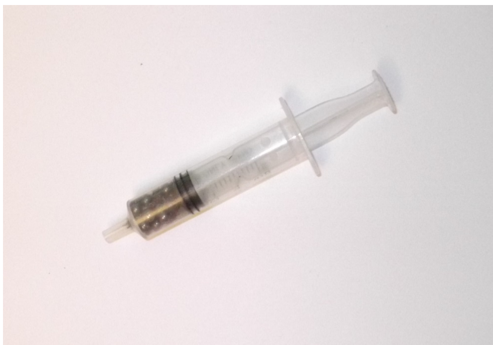
Рисунок 9 Шприц, наполненный смесью стальных шариков и металлической стружки
