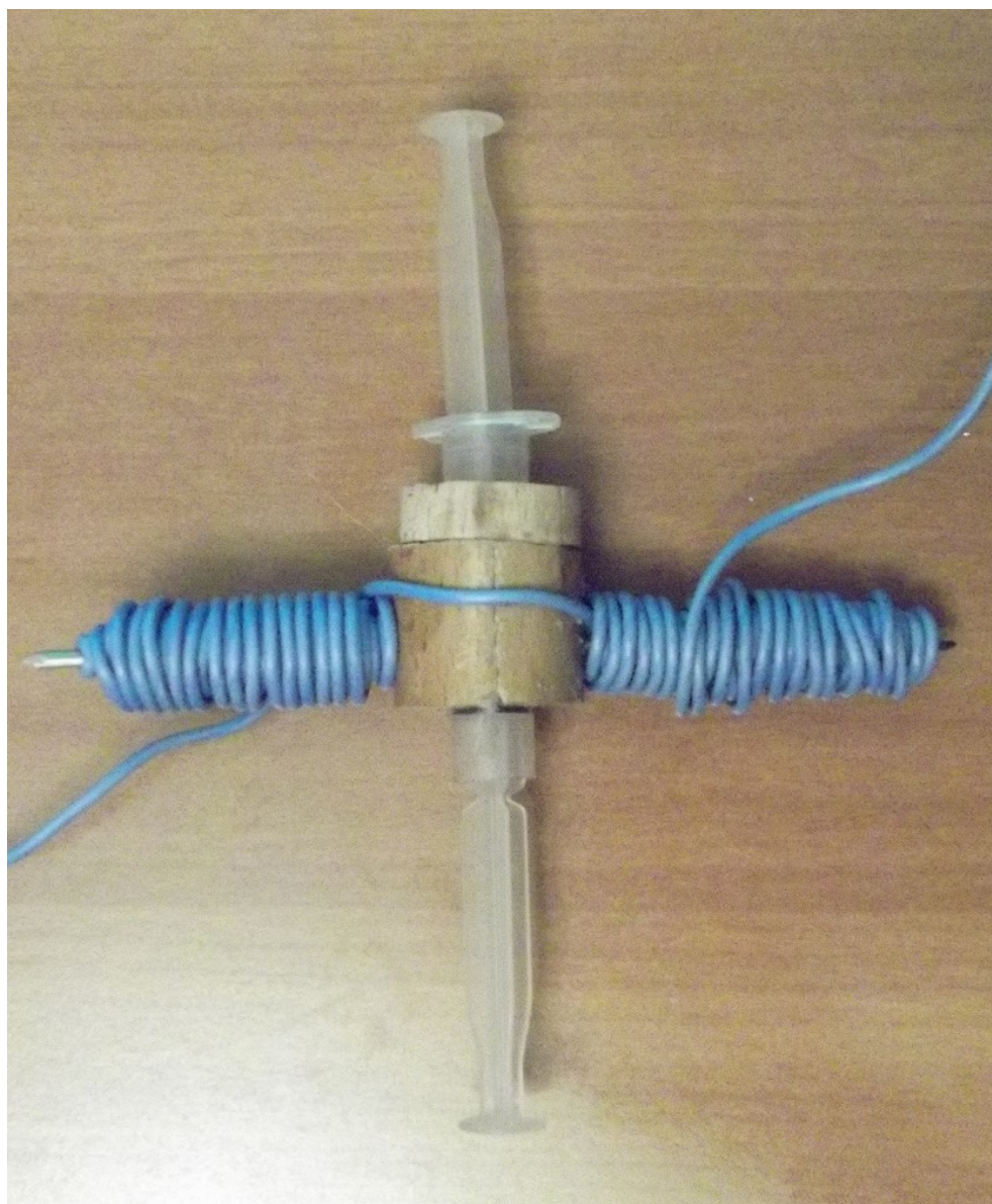
Рисунок 11 Собранный модель (по бокам два гвоздя, обмотанные медным проводом)
