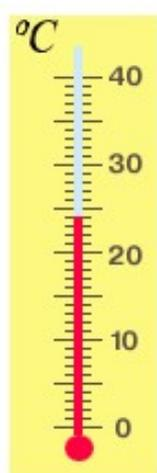
Используемые в быту термометры измеряют температуру в градусах Цельсия ( $^{\circ}\text{C}$ ).
