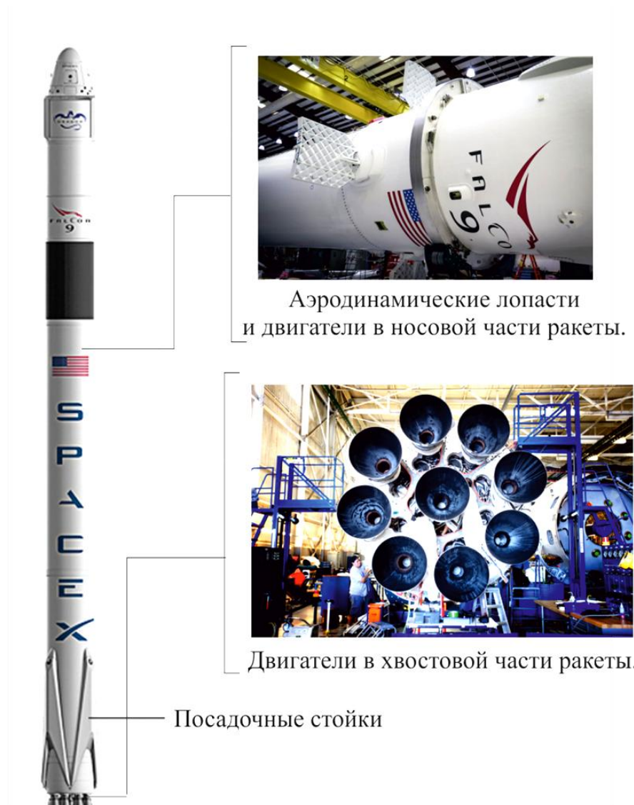
Рис. 4. Способы корректировки траектории ракеты
