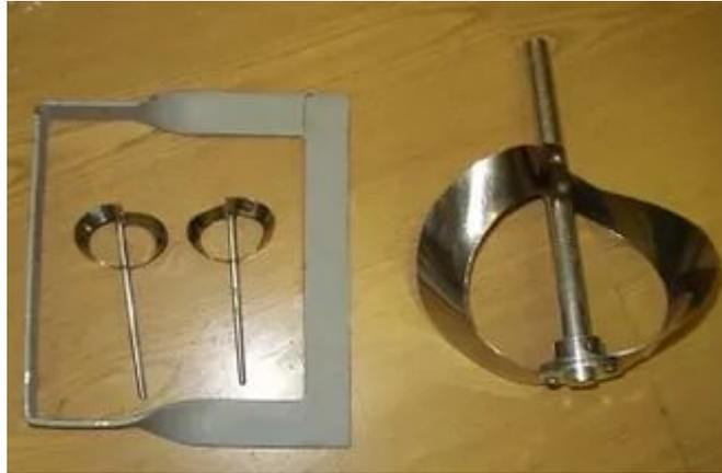
Полоса ленточного конвейера выполняется в виде ленты Мёбиуса, что позволяет ему работать дольше, потому, что вся поверхность ленты изнашивается равномерно.
