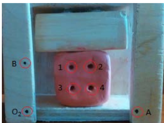
Рис. 3 А, В, О – точки на установке, которые стали началом новых координат. 1, 2, 3, 4 – точки на пластилиновом образце, движение которых отслеживалось в данном опыте.
