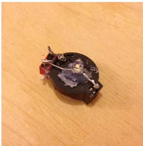
Рис. 7. Батарейный отсек, выключатель и светодиод
