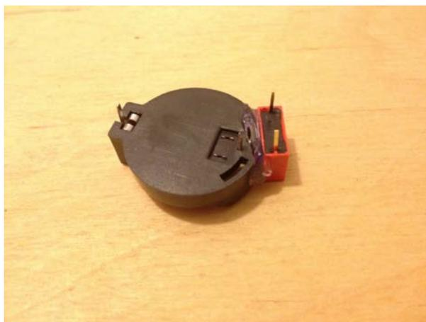
Рис. 5. Батарейный отсек и выключатель.
