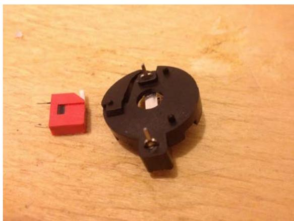
Рис. 4. Батарейный отсек и выключатель.
