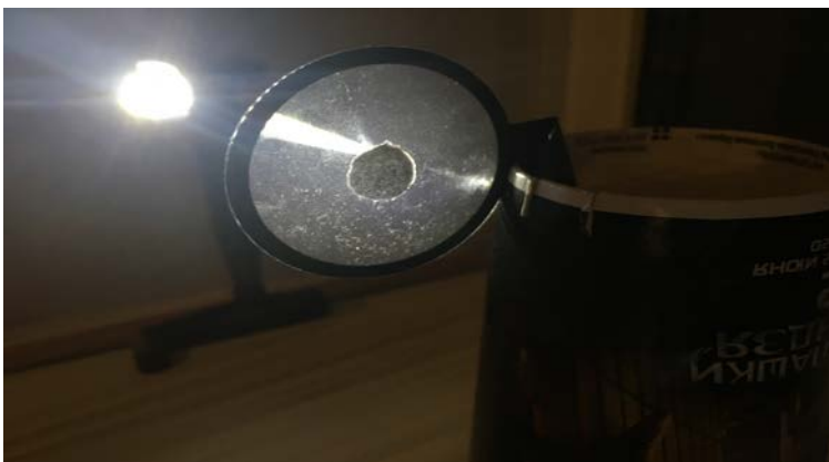
Рис. 13. Измерение фокусного расстояния линзы с перекрытием
