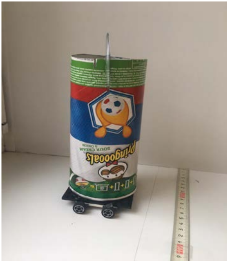
Рис. 11. Подвижное устройство для удержания и перемещения линзы
