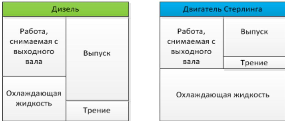
Рис. 3 Сравнение структур энергетического баланса двигателя Стирлинга и дизельного двигателя.
