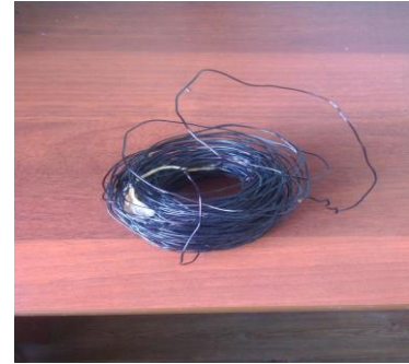
(Рис.П.2.2) Провод первичной катушки
