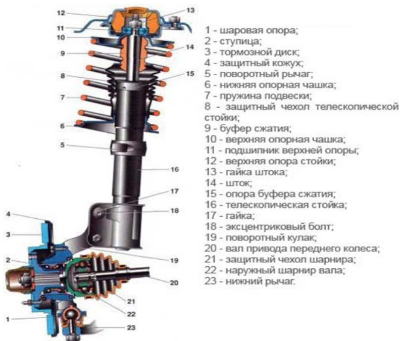
Рис.5. Обобщенная схема пружинной подвески
