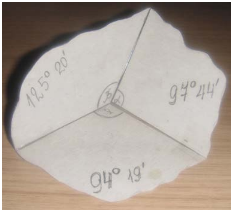
Двугранные углы кристалла медного купороса
