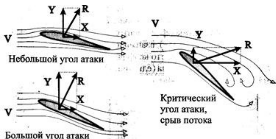
Рис.6. Различные углы атаки (X – лобовое сопротивление, Y – подъемная сила)
