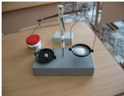
Рис.2.Рычажные весы (с разновесами)
