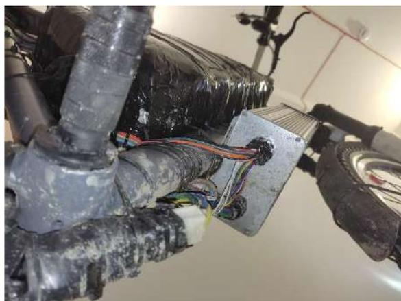
Рис. 26 Установленный контроллер
