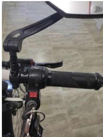
Рис. 35 Установленная ручка газа
