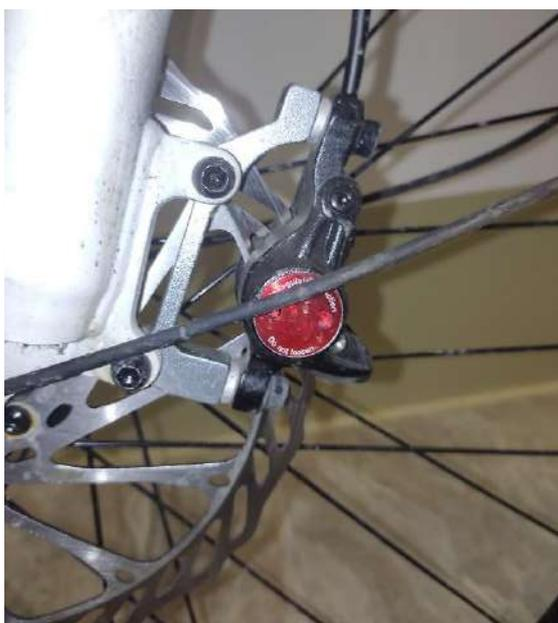
Рис. 17 Передний тормоз
