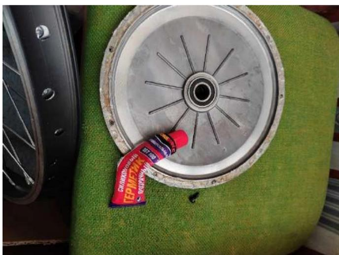
Рис. 21 Герметизация двигателя
