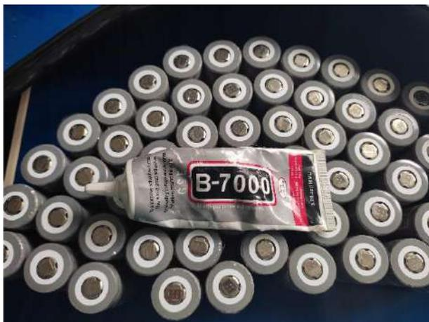
Рис. 27 Дополнительная изоляция аккумуляторов
