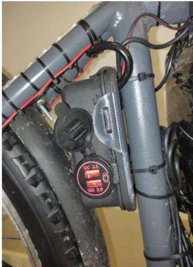
Рис. 42 Блок управления светом
