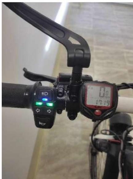
Рис. 39 Пульт управления и спидометр
