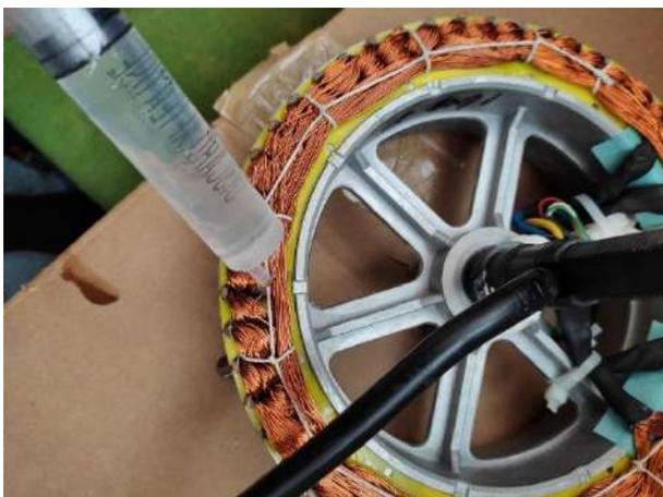
Рис. 19 Пропитка обмоток статора лаком
