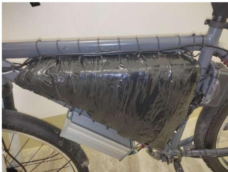
Рис. 32 Установленная батарея
