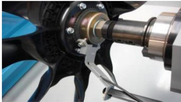
Рис. Вентилятор двигателя с датчиком Холла
